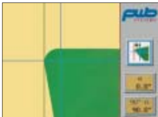
Maximumsuche, grösster Durchmesser wird mit grüner Linie angezeigt
